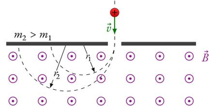
Los iones de carga  $q$  conocida son acelerados por la acción de una diferencia de potencial  $\Delta V$  y penetran en una región en la que existe  $\vec{B}$  uniforme generado por un electroimán.
