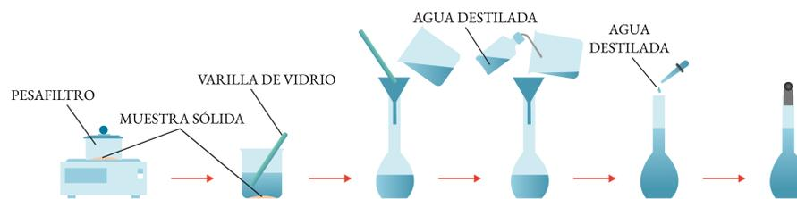
1: Pesamos la masa necesaria de soluto. 2: Añadimos el soluto al matraz aforado, junto con una pequeña cantidad de agua destilada para disolver. 3: Después de disolver el soluto, llenamos el matraz con agua destilada hasta el aforo. Traducida y adaptada de
